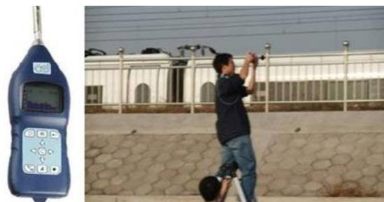
(a) 实时分析声级计 (b) 列车实车噪声测量
