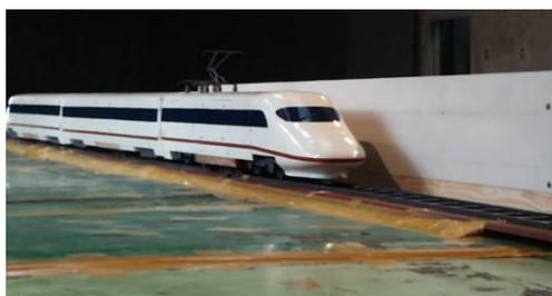
图 5 列车模型交会压力测量
