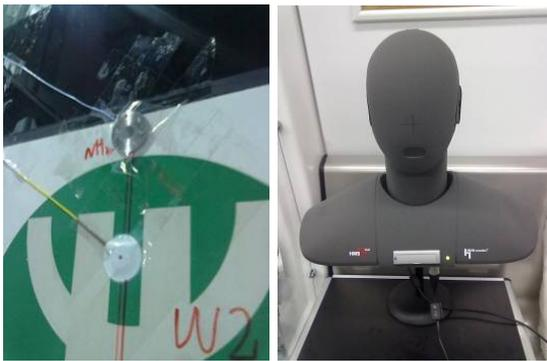
(a) 车头外部噪声测量 (b) 车厢内部噪声测量
